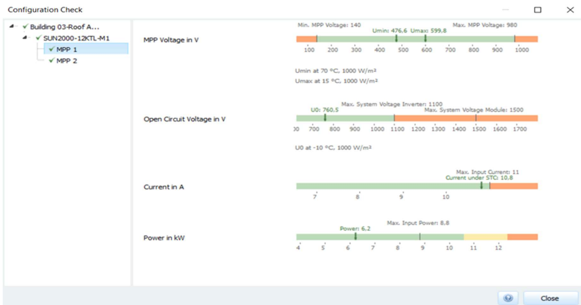
Slika 4.10. Prikaz parametara za MPP1 ulaz u izmjenjivač
