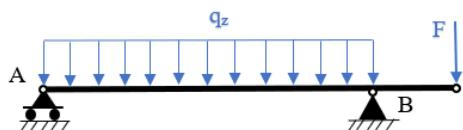
Slika 1.2 Nosač s jednim prepustom
