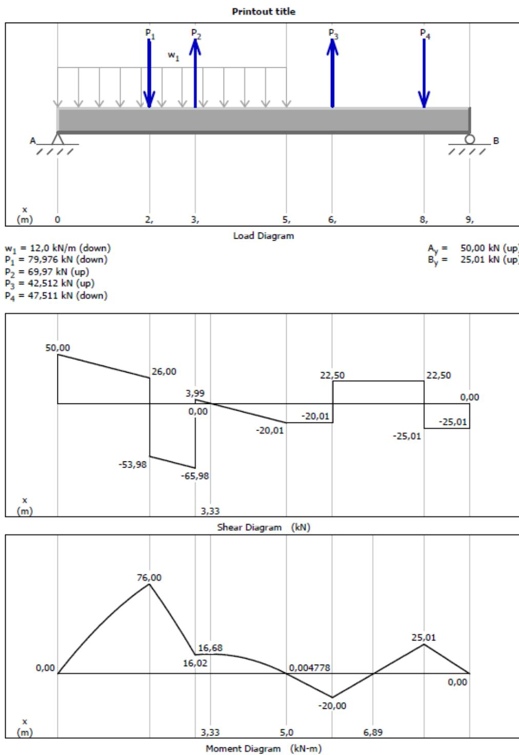
Slika 2.16 Dijagram unutarnjih sila ojačane grede iz programskog paketa MDSolids
