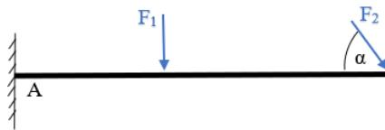
Slika 1.3 Konzolni nosač s uklještenjem na lijevom kraju
