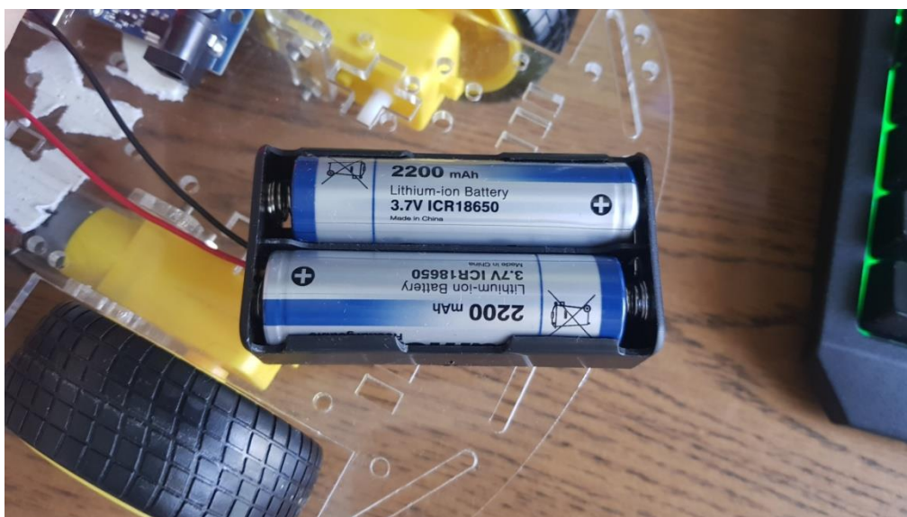
Slika 2.4.3. Li-ion baterije napajanja 2x 3.7V
