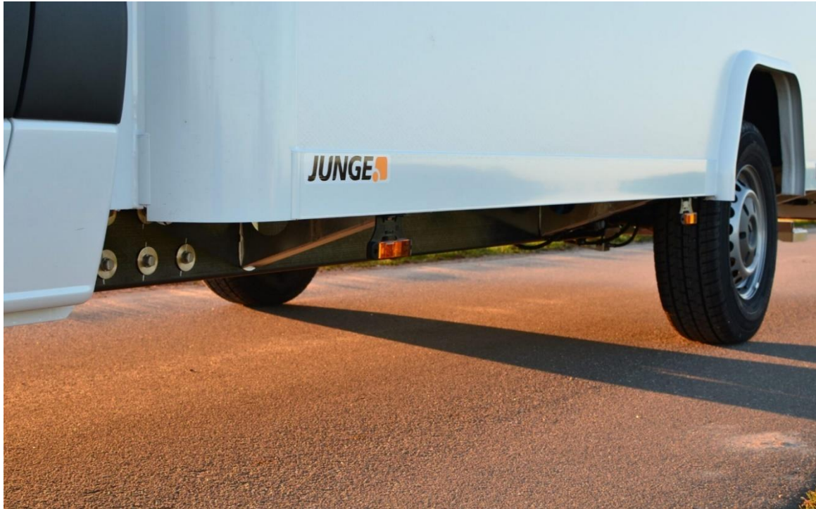
Slika 2.19 – Detalj dijela kompozitne šasije komercijalnog kombi vozila [26].
