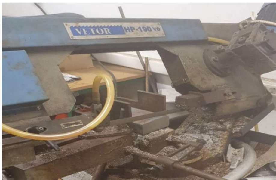
Slika 3. 8 – Rezanje sirovca na tračnoj pili
