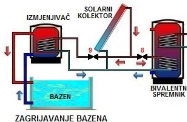
Slika 4.1. integracija solarnog sustava za grijanje bazena [11]
