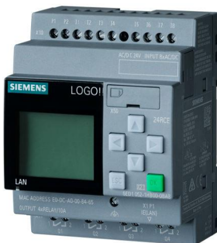
Slika 5.1. LOGO! PLC uređaj sa display-om [14]
