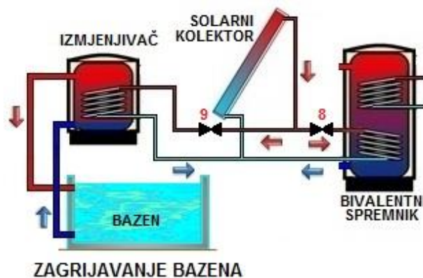
Slika 4.1. integracija solarnog sustava za grijanje bazena [11]
