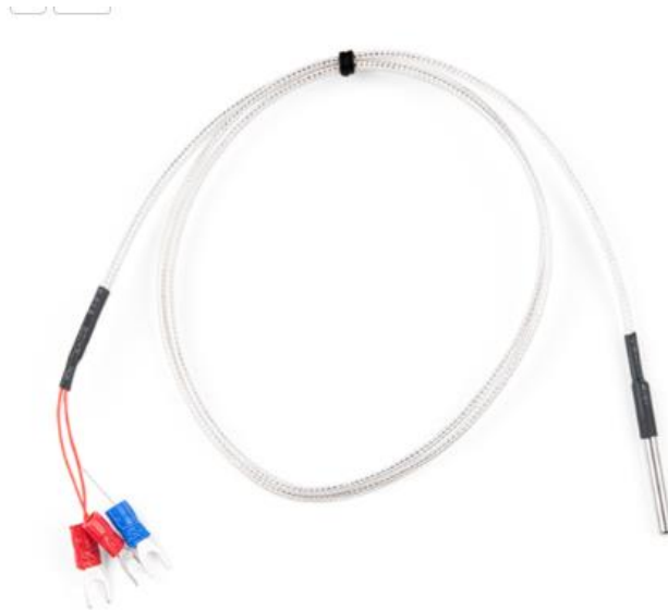
Slika 9.2. PT100 od platine [16]
