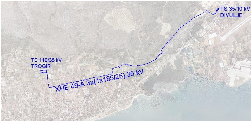
Slika 7.2. Trasa ispitivanog kabela
