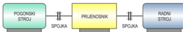
Slika 3.22 - Shematski prikaz funkcije spojke [19]
