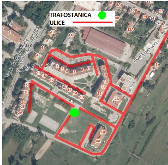
Slika 4.5.1. Područje napajanja trafostanice Barice
