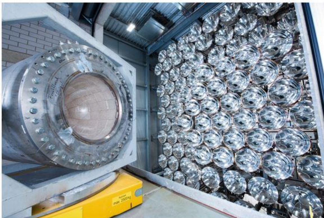
Slika 2.8 Reaktor za termokemijsko stvaranje vodika u SynLight -u (DLR lokalitet, Jülich) [7]
