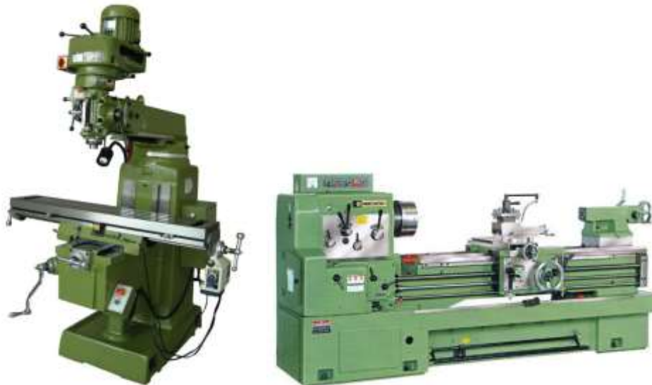
Slika 1.2 - Ručno upravljana glodalica; Ručno upravljana tokarilica [2] [3]
