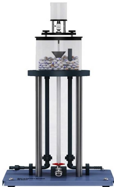
Slika 3.3 – Izgled stvarnog vertikalnog modela Reynoldsovog eksperimenta „FM-1849-09“ tvrtke „Infinit Technologies“ [7]
