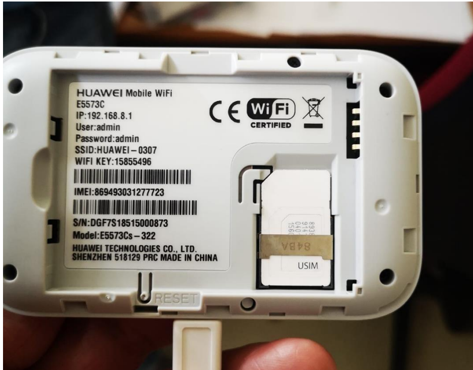
Slika 5.2. 2. SIM utor s prikazom osnovnih informacija o uređaju
