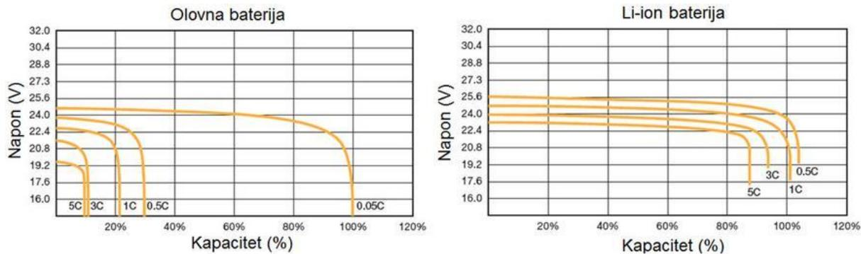
Slika 2.2. Ovisnost napona i kapaciteta o struji pražnjenja [2]
