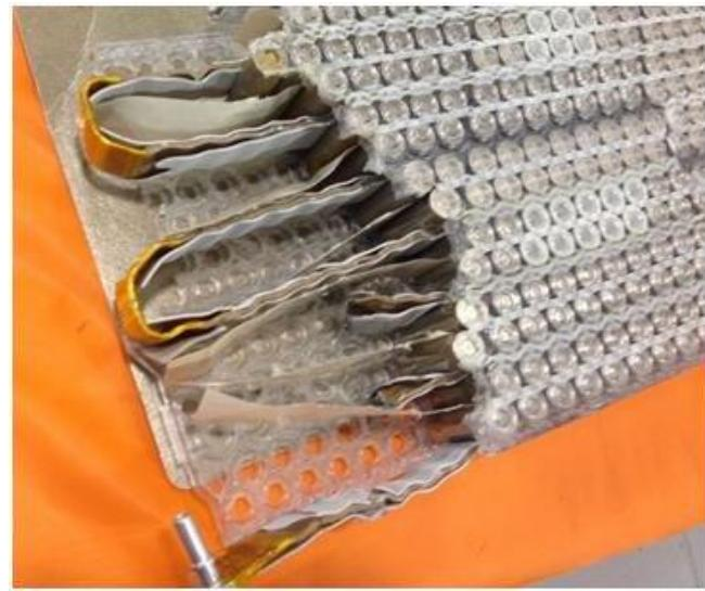
Slika 3.19. Teslina izvedba cilindričnih litij-ionskih baterija [10]
