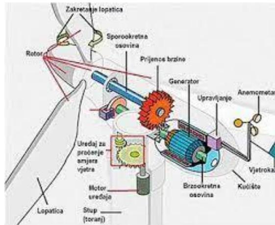
Slika 7. Kućište vjetroagregata [2]
