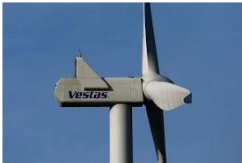
Slika 2. Vjetroagregat marke Vestas V112 [5]
