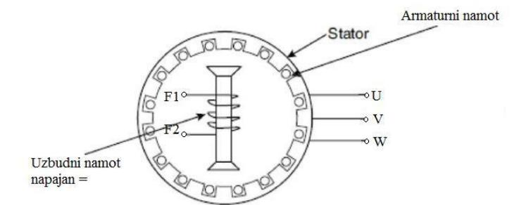
Slika 11. Stator i elementarni namot sinkronog stroja [4]
