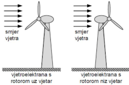
Slika 3. Vjetroagregat s horizontalnom osi vrtnje [2]
