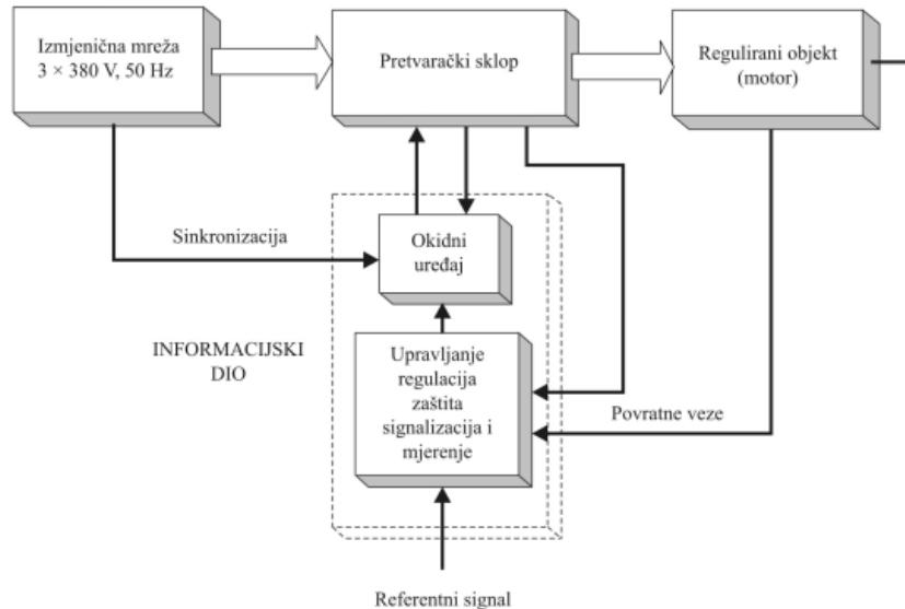
Slika 18. Sklop s frekvencijskim pretvaračem [6]
