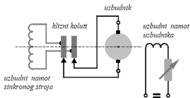
Uzbudni sistem s istosmjernim uzbudnikom
