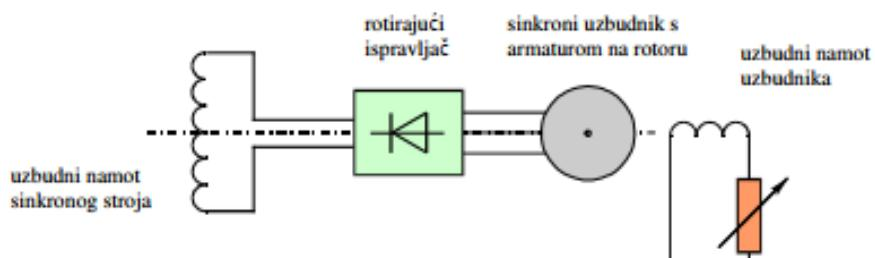
Slika 15. Beskontaktna uzbuda sinkronog stroja [4]
