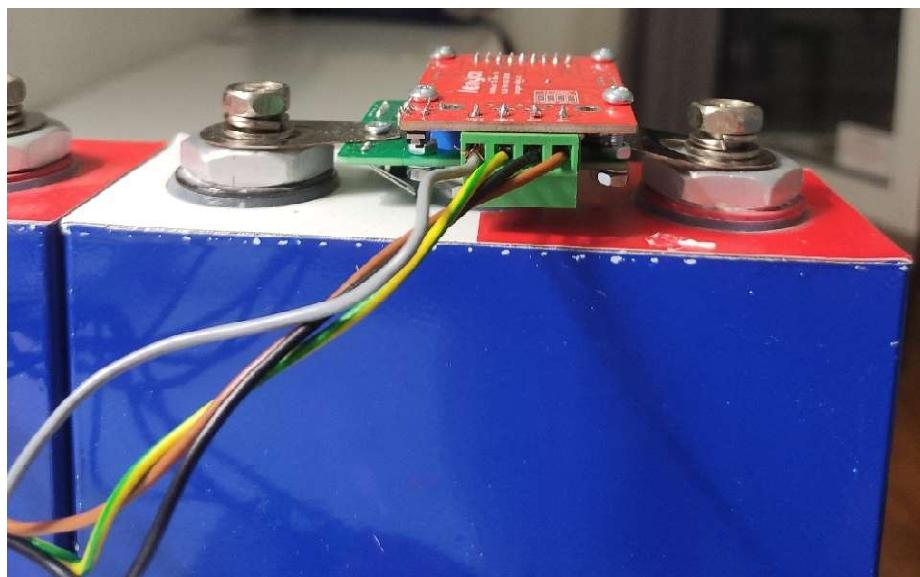
*Slika 4.4. Čelijski modul nakon montaže*
