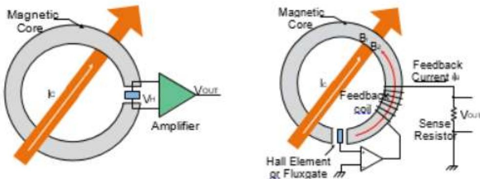
Slika 3.6. Senzor otvorene (lijevo) i zatvorene (desno) petlje [8]
