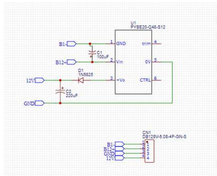
Slika 4.6. Shema prvog DC-DC pretvarača iz paralele
