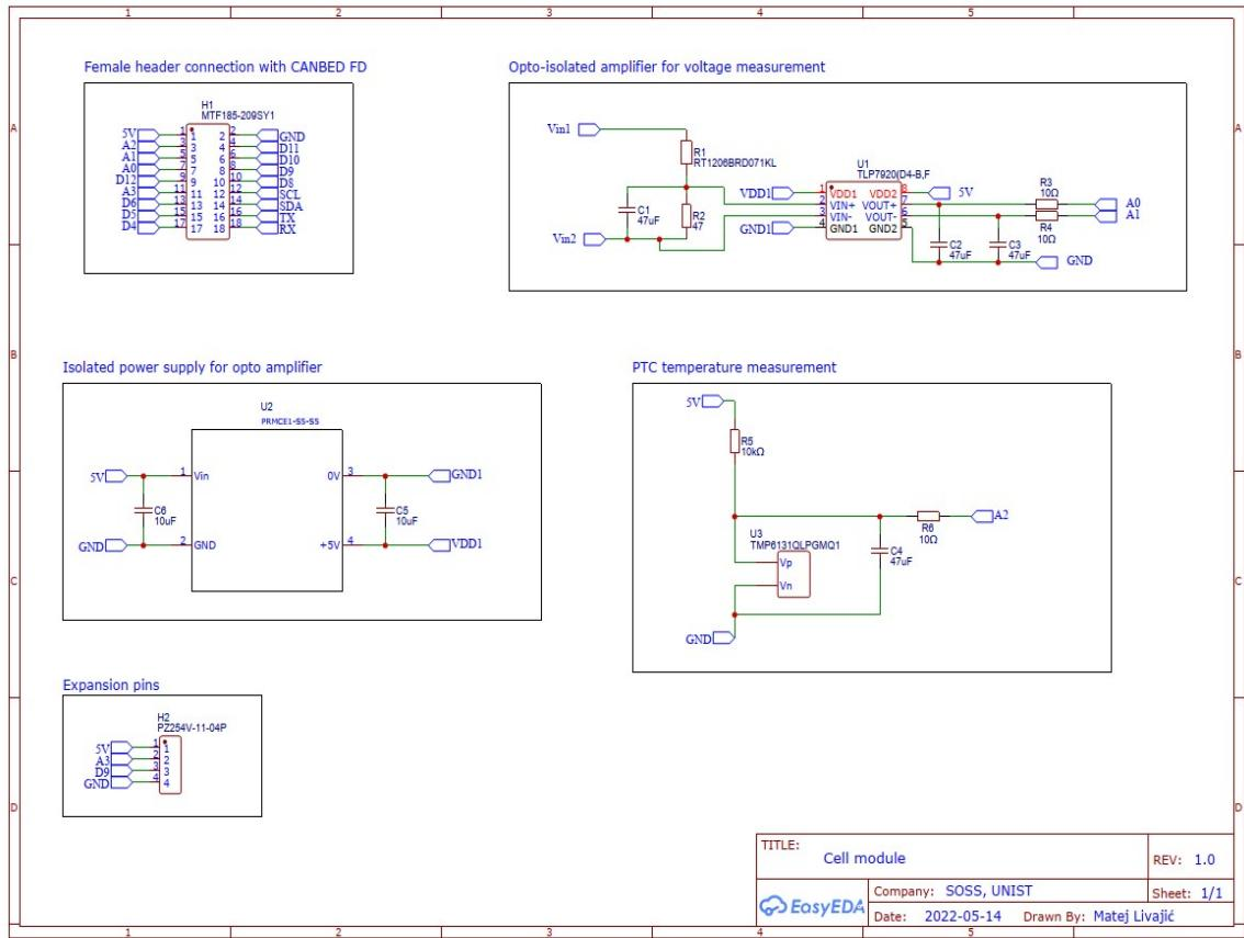
Slika 4.5. Shema druge pločice čelijskog modula
