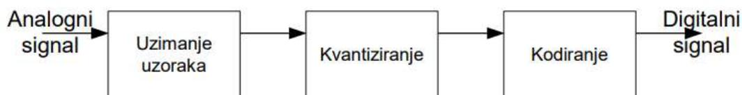
Slika 3.7. Proces analogno digitalna pretvorba [9]
