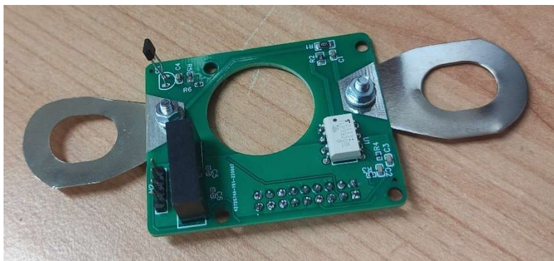
Slika 4.3. Izgled druge pločice ćelijskog modula
