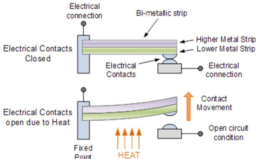
Slika 3.3. Bimetalni termostat [6]
