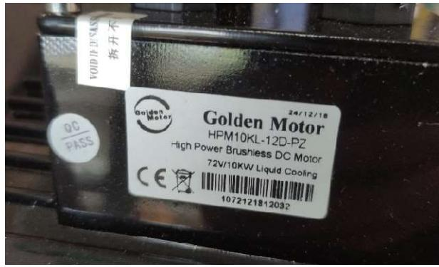
Slika 2.4. Prikaz pločice elektromotora
