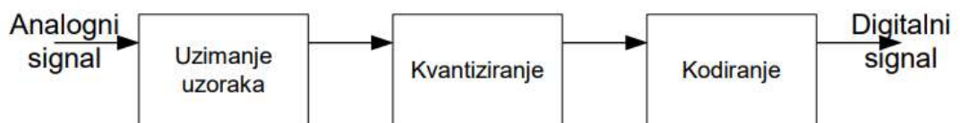
Slika 3.7. Proces analogno digitalna pretvorba [9]
