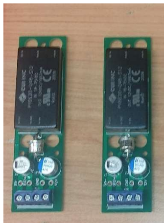
Slika 4.7. Pločice napajanja nakon izrade
