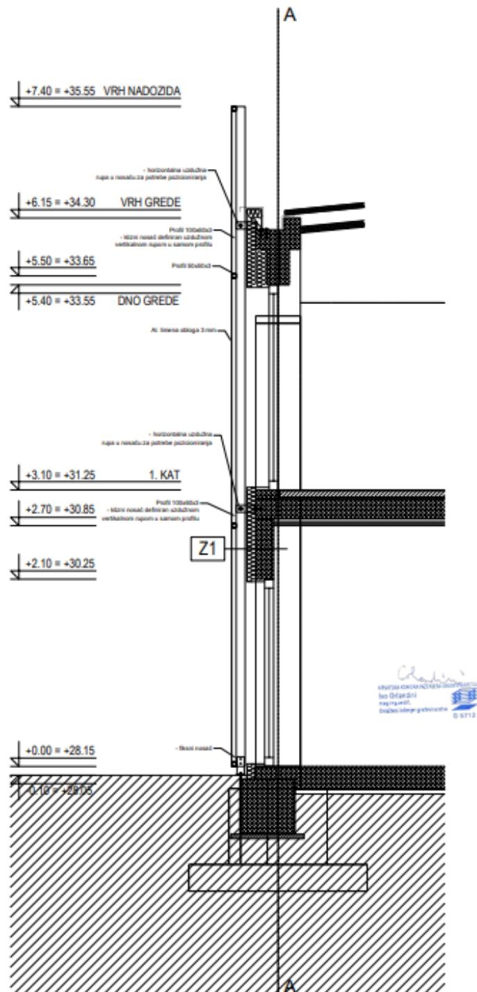
Slika 5.15 - Presjek spoja potkonstrukcije
