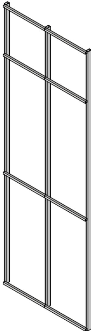
*Slika 5.14 - Prikaz 3D modela čelične potkonstrukcije za prihvatanje fasade*
