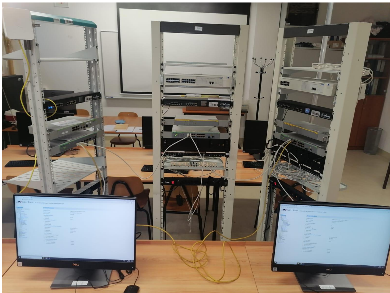
Slika 11.1 Mreža za demonstraciju protokola rasponskog stabla
