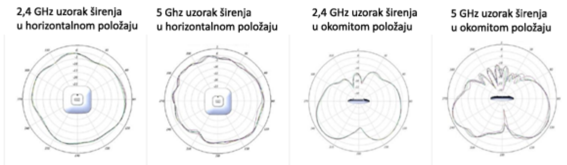
Slika 31:Širenje signala ugrađene antene pristupne točke Cisco 1700 serije [16]
