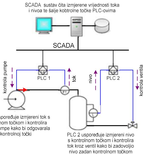
Slika 5.3. SCADA sustav, primjer slanja podataka
