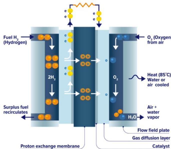
Slika 4.5. Princip rada gorive čelije [18]
