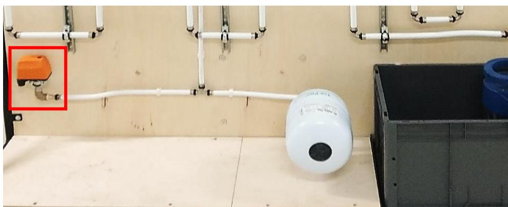
*Slika 3.22 – Presostat (tlačna sklopka)*
