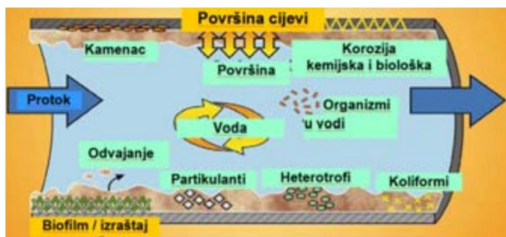
Slika 2.4 – Nečistoće unutar cijevi [4]
