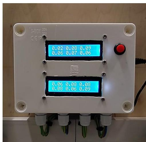
Slika 4.3 – Digitalni mjerač tlaka
