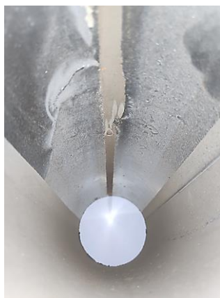
Slika 2.5 – Primjer nakupljene nečistoća unutar cijevi [4]
