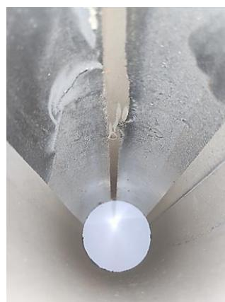
*Slika 2.5 – Primjer nakupljene nečistoća unutar cijevi [4]*
