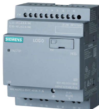
Slika 2.1 Siemens LOGO!8 PLC kontroler [1]
