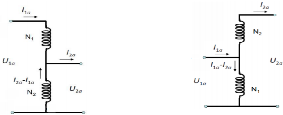
Slika 4.2. 1. Silazni i uzlazni autotransformator [5]
