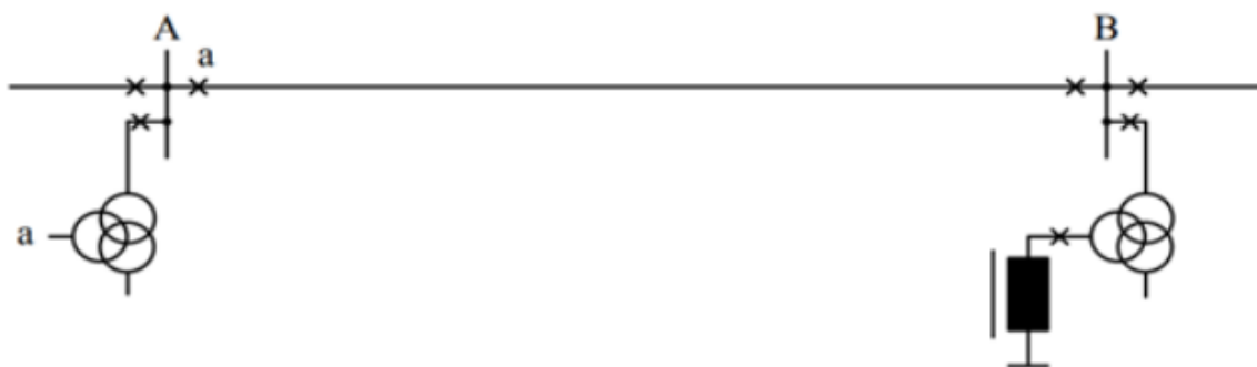
Slika 7.4.2. Kompenzacijska prigušnica spojena na tercijar transformatora [5]
