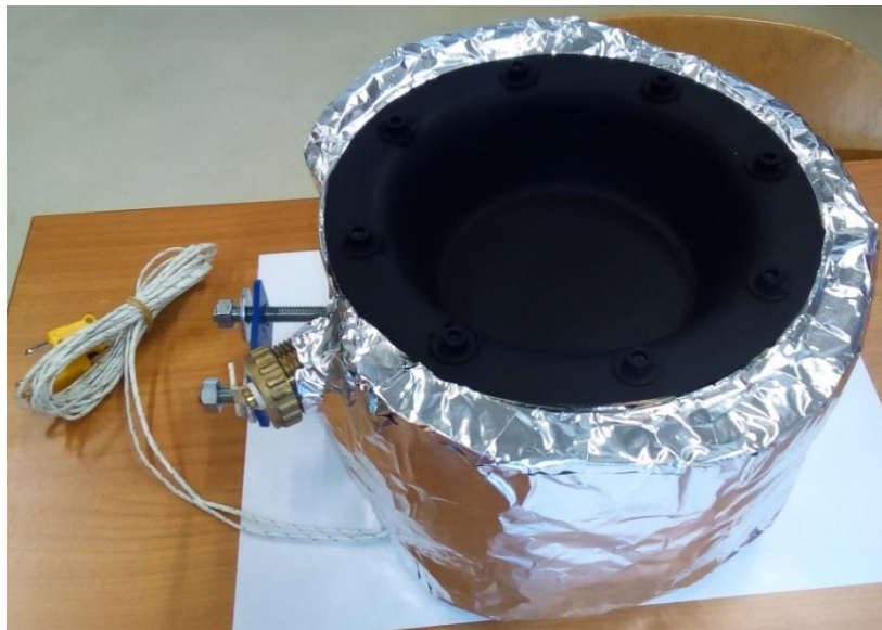
Slika 3.4. – Grijač nakon izoliranja i bojenja prednje površine
