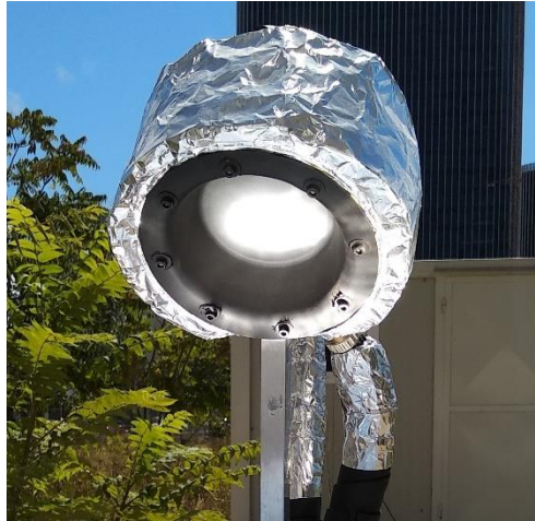
Slika 3.5.- Fokusiranje sunčevog zračenja na grijaču
