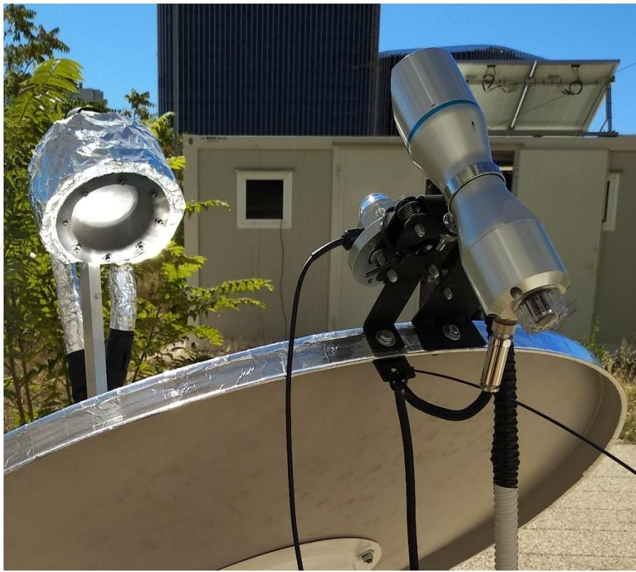
Slika 4.3. – Piranometar i pirhelijometar u radu
