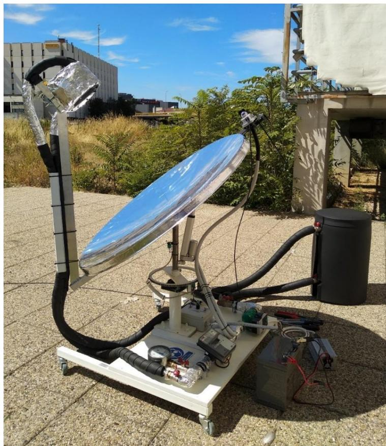
Slika 4.1. – Parabolični solarni koncentrator u radu
