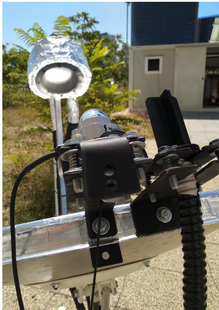
*Slika 3.10. – Spojeni fotoosjetljivi osjetnik i piranometar*
