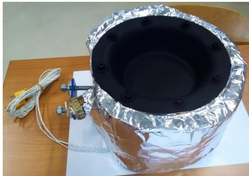
*Slika 3.4. – Grijac nakon izoliranja i bojenja prednje površine*
