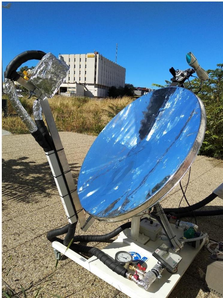
Slika 4.2. – Piranometar i pirheliometar spojeni na solarni koncentrator
