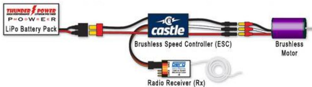
Slika 4. Prikaz kontrolera brzine sa sastavnim dijelovima. [2]
