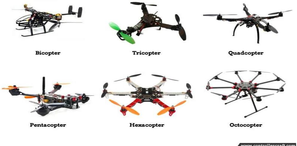
**Slika 14.** Vrste multikoptera po broju motora. [17]
