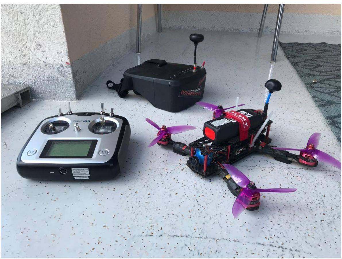
**Slika 33.** Višemotorna bespilotna letjelica s video vezom i sustavom za upravljanje
