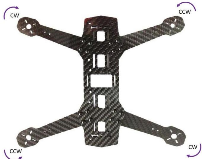
**Slika 27.** Smjer vrtnje propelera tj. motora
