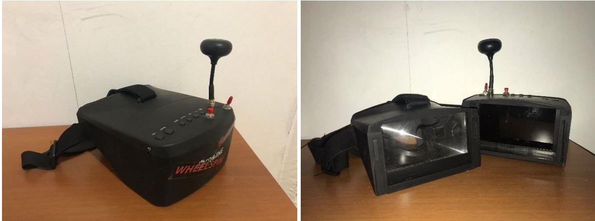
Slika 26. Naočale za video prijenos korištene u radu
