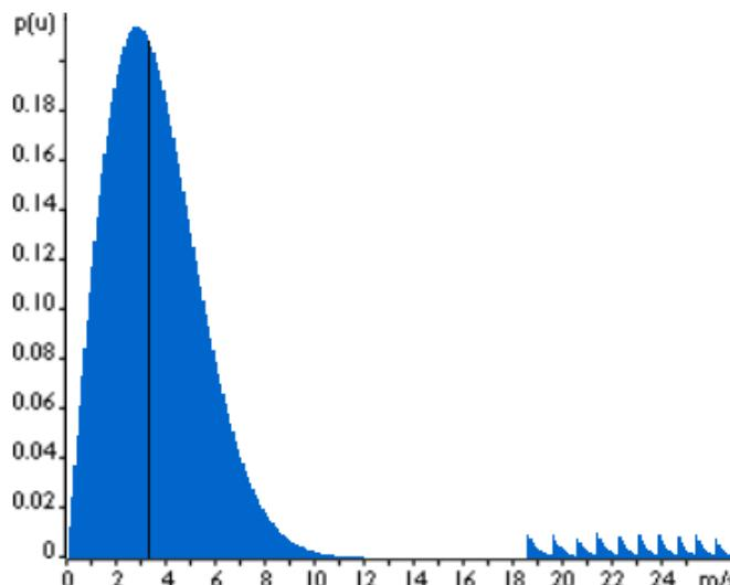
*Slika 5.5.- Weibullova funkcija dobivena utjecajem parametara  $A=4 \text{ m/s}$ ,  $k=2$  [18]*
