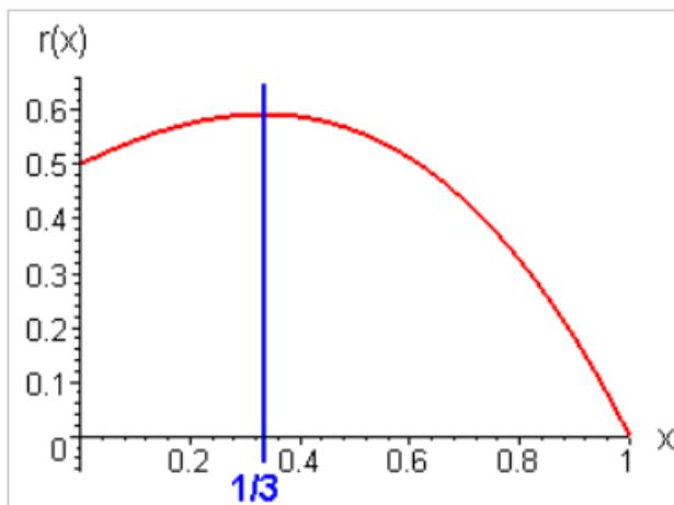
Slika 2.2.- Koeficijent  $C_p$  s obzirom na  $v_2/v_1$  [8]
