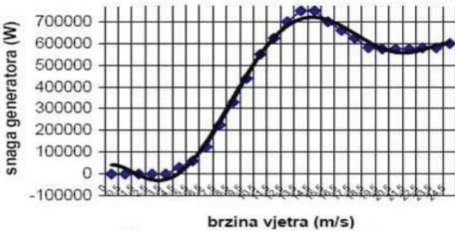
Slika 2.5.- Ovisnost snage vjetrogeneratora o brzini vjetra [12]
