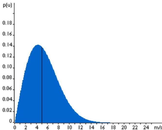
Slika 4.2.- Weibulova funkcija parametara  $A=6,0\text{ m/s}$  i  $k=2$  [18]
