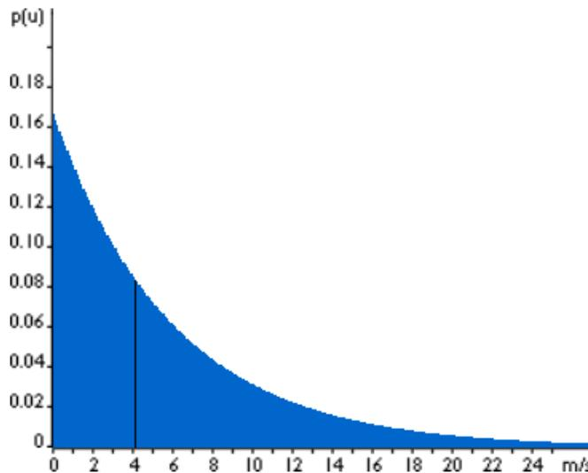
*Slika 5.3.- Weibullova funkcija dobivena utjecajem parametara  $A = 6 \text{ m/s}$ ,  $k=1$  [18]*
