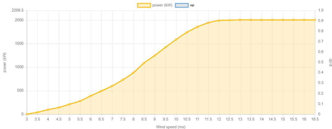
*Slika 3.3.- Krivulja snage za vjetroagregat Vestas V90- 2 MW [16]*
