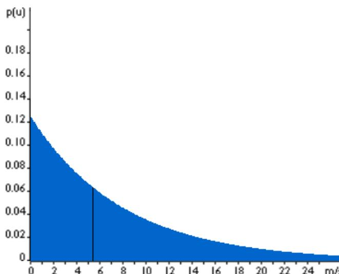
Slika 7.1.- Weibullova funkcija dobivena utjecajem parametara  $k = 1$  i  $A = 8 \text{ m/s}$  [18]
