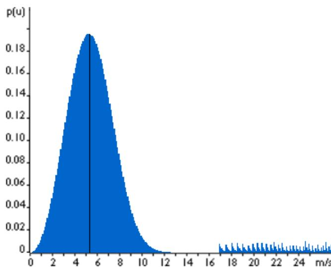
Slika 5.1.- Weibulova funkcija dobivena utjecajem parametara  $A = 6 \text{ m/s}$ ,  $k = 3$  [18]
