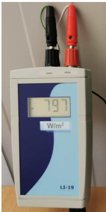
Slika 3.11 - LI-19 data logger
