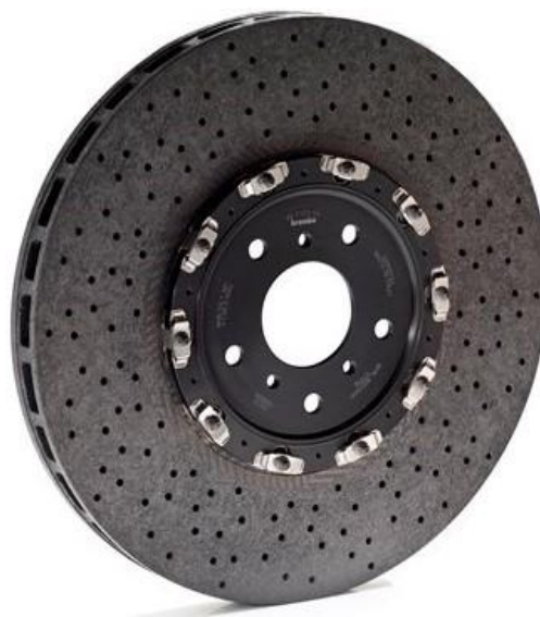
Slika 2.2 - Kočioni disk od kompozita keramičke matrice [13]
