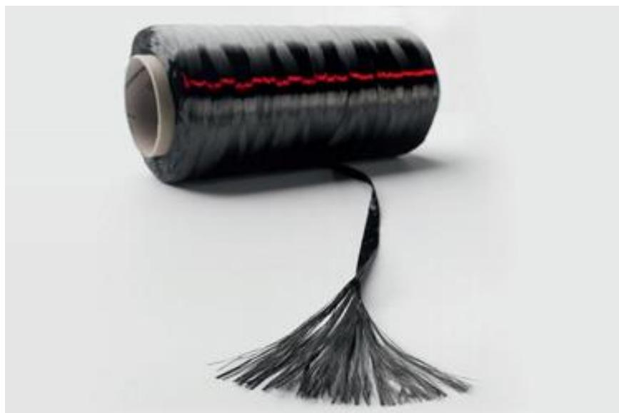
Slika 3.3 - Namotana ugljična vlakna na špulu (tow) [19]
