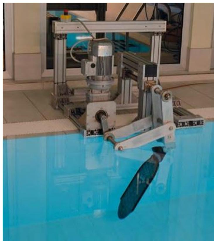
Slika 1.12 - Ispitivanje dinamičke čvrstoće peraja [10]
