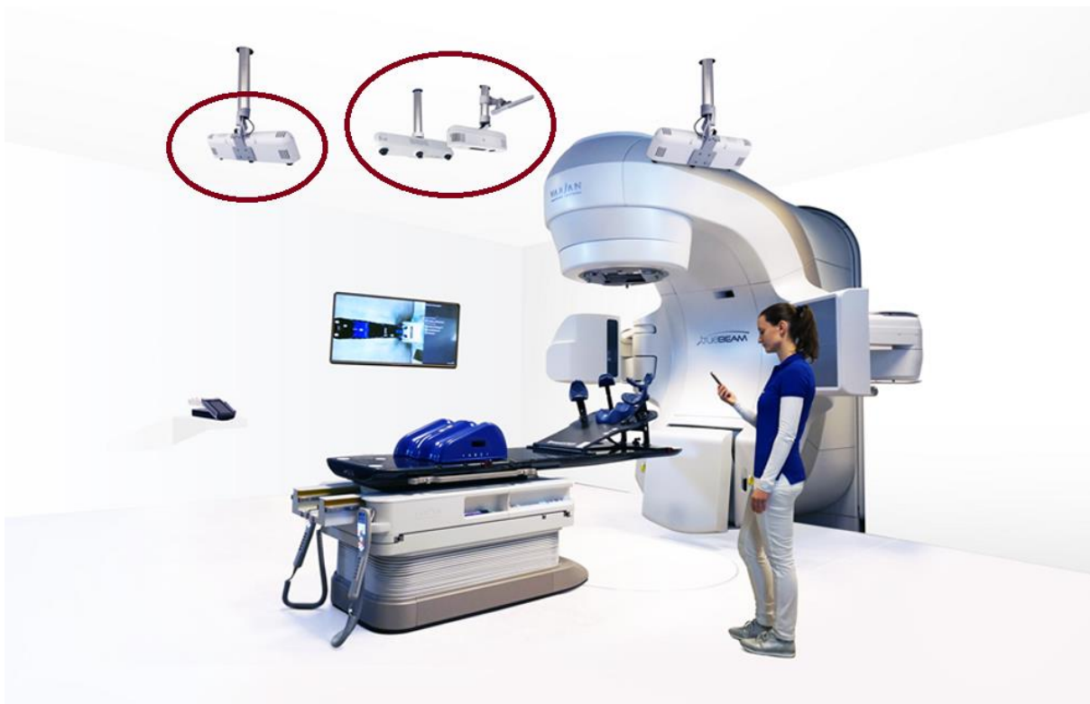
Slika 3.5. Konfiguracija IDENTIFY sustava [16]
