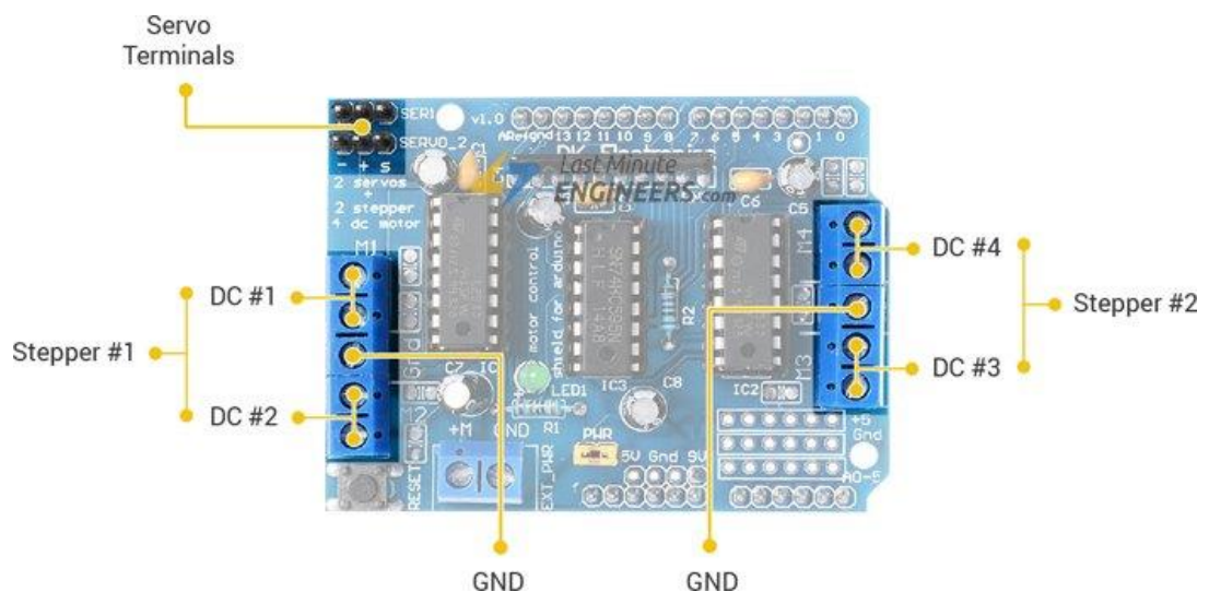
Slika 4.22. Raspored izlaznih stezaljki za priključak motora [35]
