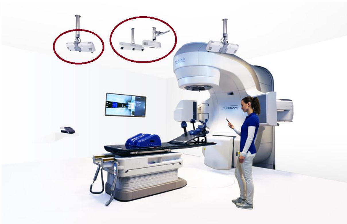
Slika 3.5. Konfiguracija IDENTIFY sustava [16]
