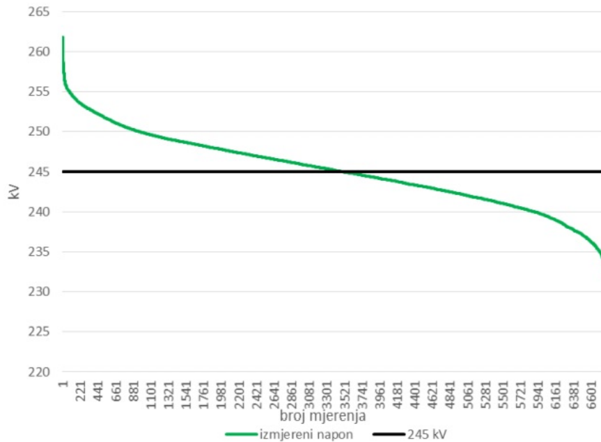
Slika 4.37. Dijagram trajanja napona u TS Prijedor 2 (220 kV) tijekom 2020.
