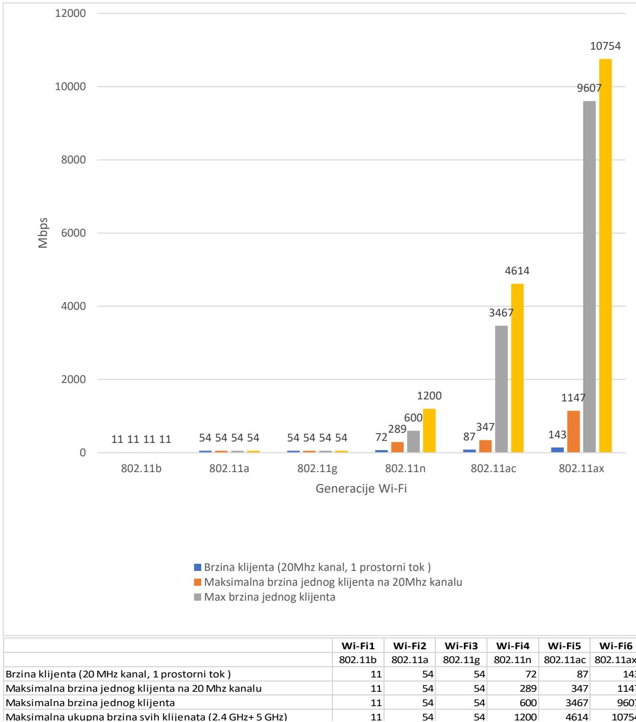
Slika 6: Usporedba brzina kod svih generacija Wi-Fi sustava
