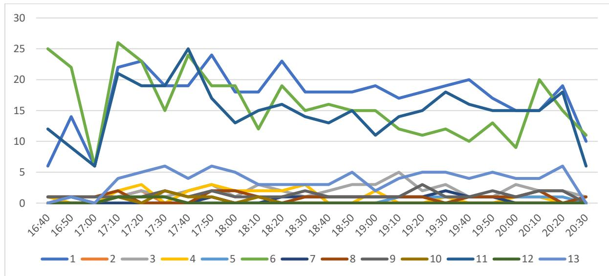
Slika 26: Broj pristupnih točaka 2.4 GHz - Chanalyzer
