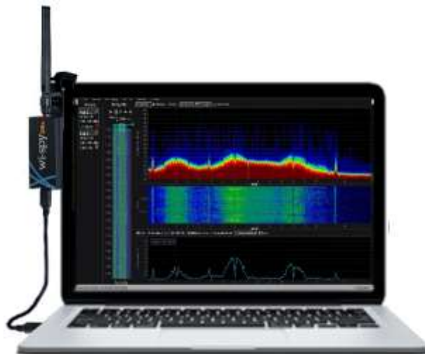
Slika 7: Primjer mjerenja spektra s Wi-Spy DBx antenom i Chanalyzerom
