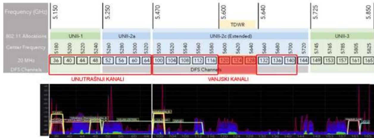
Slika 53: Dostupni kanali na 5 GHz
