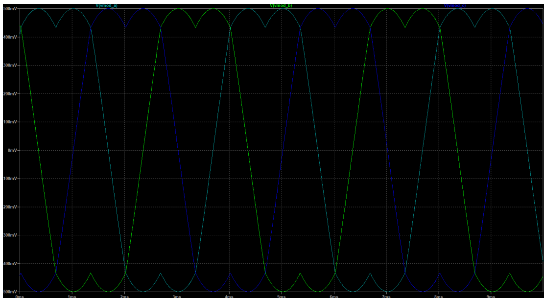
Slika 3.11: Vektorska modulacija - LTSpice simulacija
