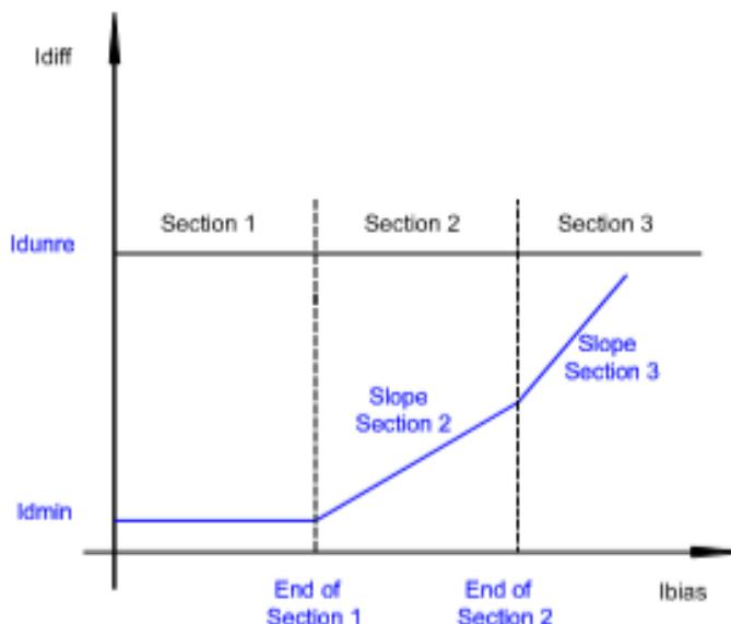
Slika 3.2. Radna karakteristika funkcije diferencijalne zaštite uređaja RET 670
