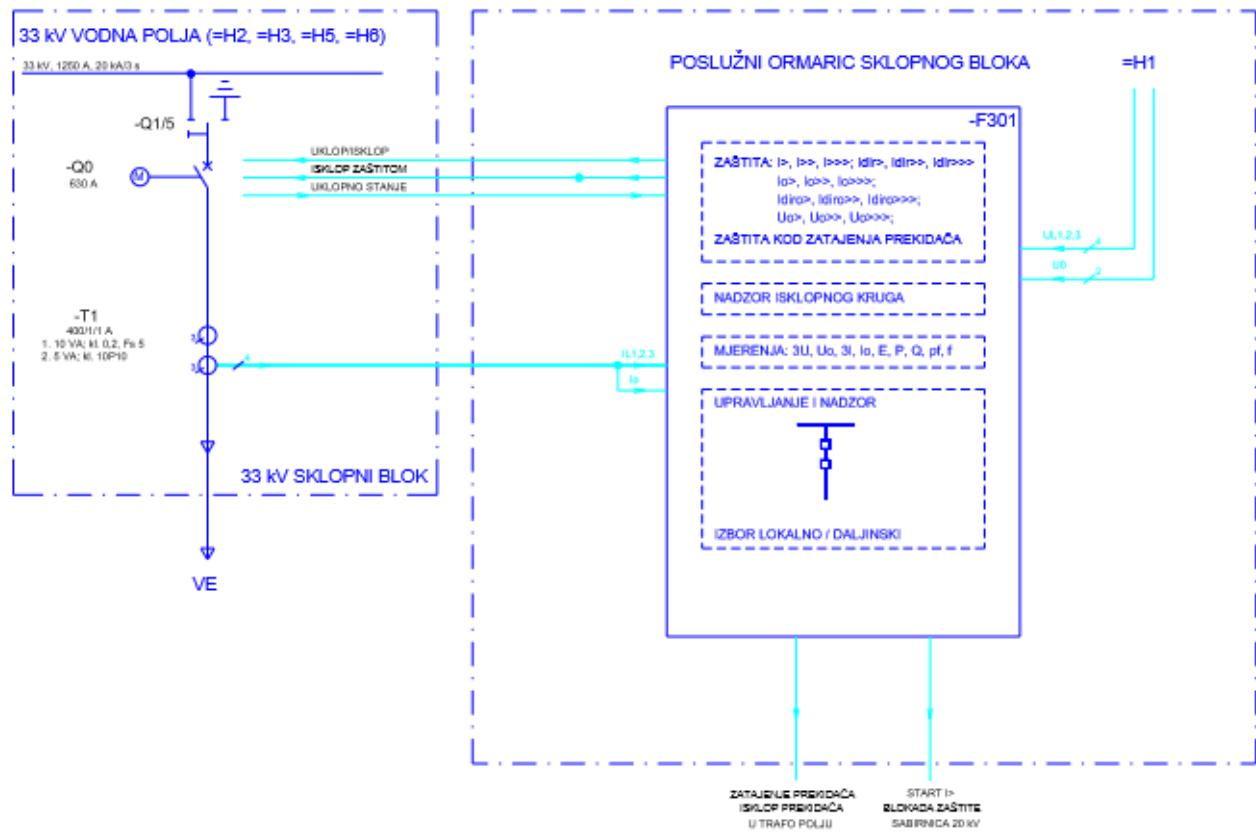
Slika 4.1. Blok shema priključka uređaja zaštite REF 615
