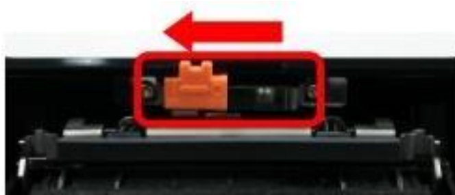
Slika 3.7. Postavljanje prekidača na lijevu stranu
