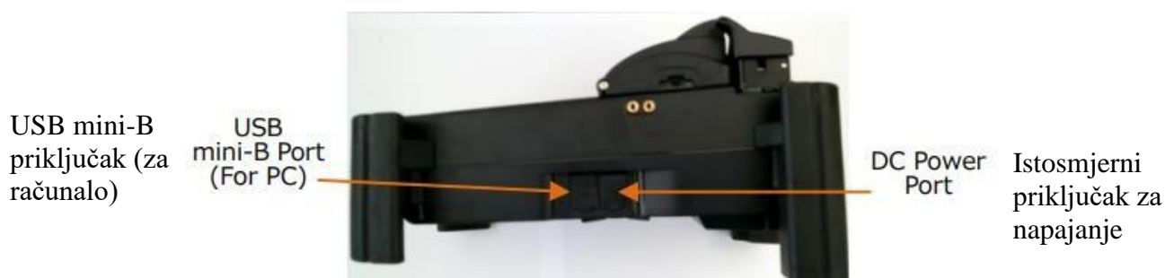
Slika 3.3. Dijelovi spajača optičkih niti
