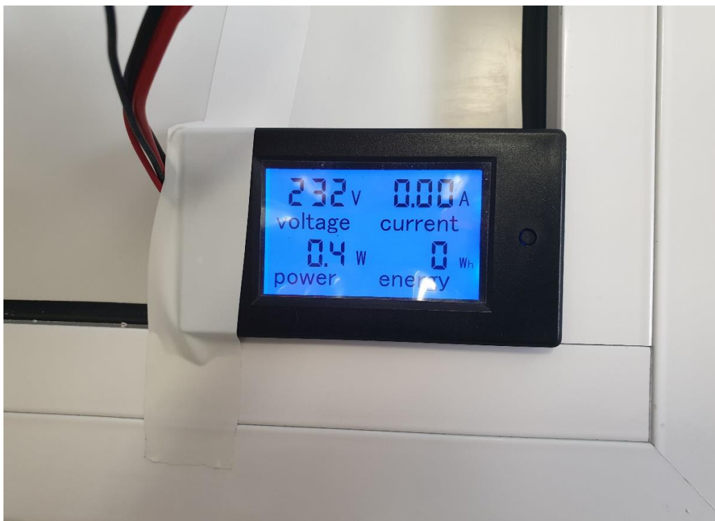
Slika 5.4 - Početno stanje digitalnog mjerila potrošnje el. energije [13]
