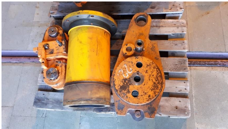
Slika 4. 27. Sastavni dijelovi mehanizma lopatice [15]
