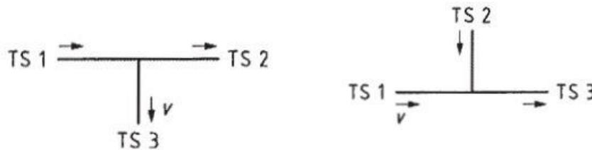
Slika 4.1 - Označavanje t komada prema DIN 1988-300 [10]
