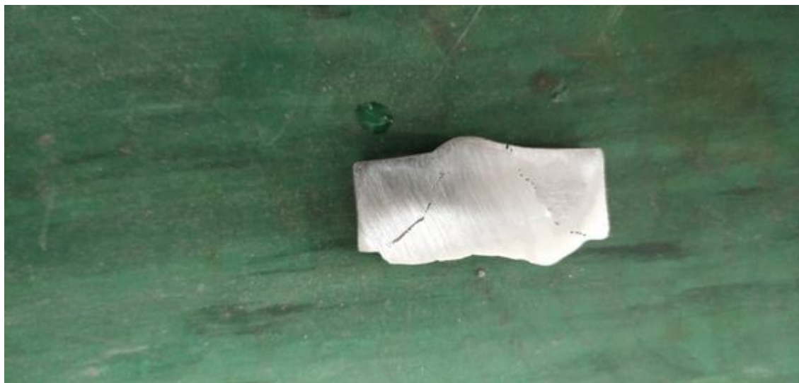
Slika 38. Izgled uzorka nakon što je držan u otopini željezovog (III) klorida u trajanju od 72 sata na temperaturi od 40 °C [30]
