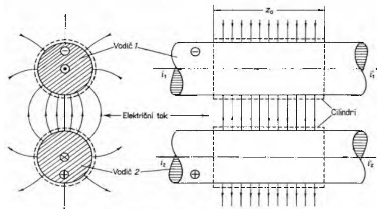
Slika 2.5. Električni tok dvožilnog voda
