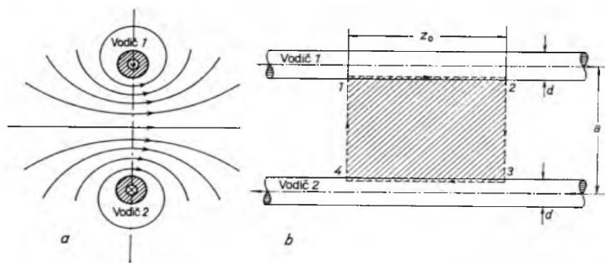
Slika 2.4. Magnetski tok i strjuna petlja niskonaponskog električnog voda s dva vodiča
