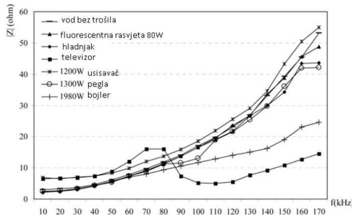
Slika 3.2. Utjecaj kućanskih uređaja na impedanciju niskonaponskog voda
