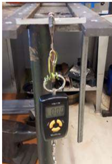
Slika 3.2 Ispitivanje vlačne čvrstoće uzorka bez vlakana
