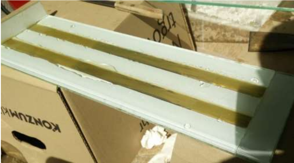
Slika 3.6 Kalup ispunjen smolom i vlaknima
