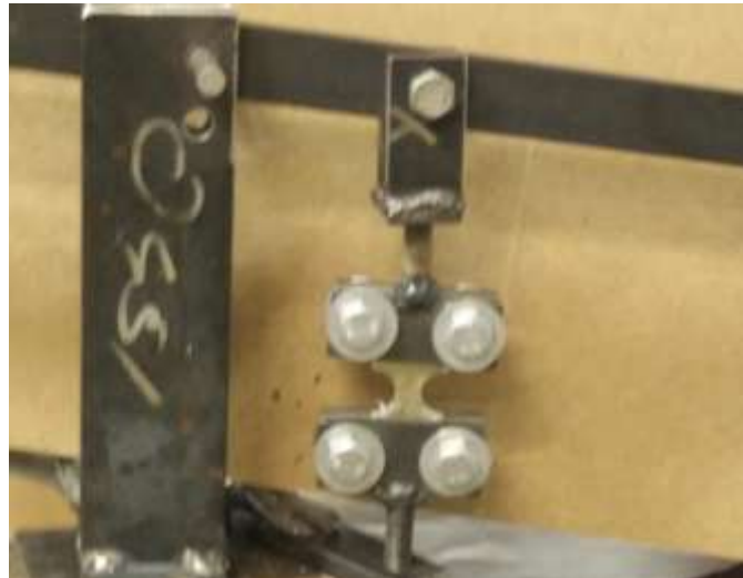
Slika 3.9 Uzorak učvršćen u čeljustima
