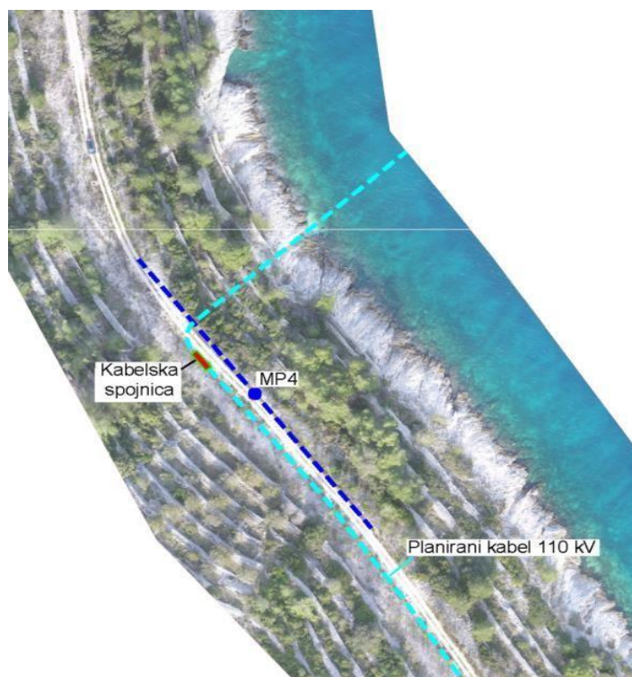
Slika 4.8 Položaj mjernog pravca uz cestu (MP4)
