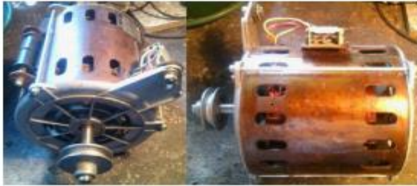
Slika 20. Izvedba motora u perilici rublja. [7]
