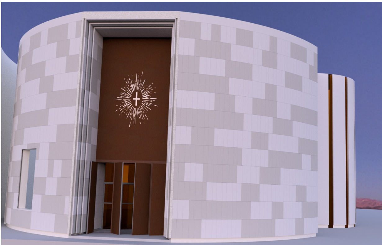
Slika 1.5 - 3D model odabrane varijante rješenja portala bazilike u Solinu [1]
