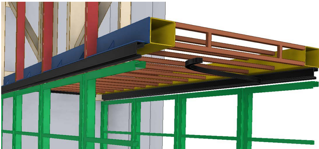
Slika 6.20 - Pomoćna konstrukcija glavnog nosača 1 [2]
