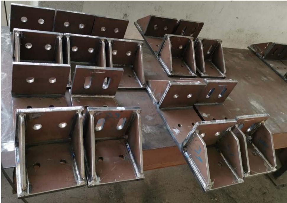
Slika 7.10 - Oslonci nosive konstrukcije u izradi
