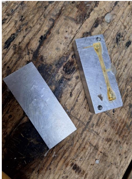
Slika 5.4 – Izliveni uzorak u kalupu
