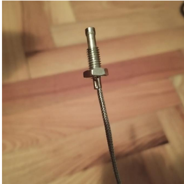
Slika 2.16 – Sonda za mjerenje temperature
