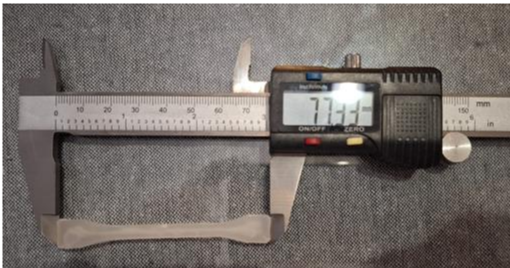
Slika 5.7 – Mjerenje duljine uzorka
