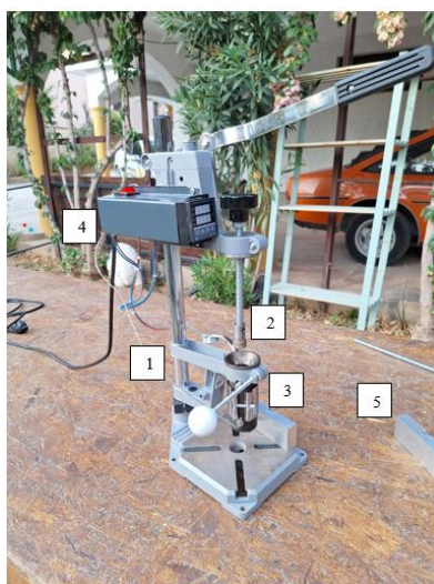
Slika 5.1 – Uređaj za ubrizgavanje polimernih ispitnih uzoraka
