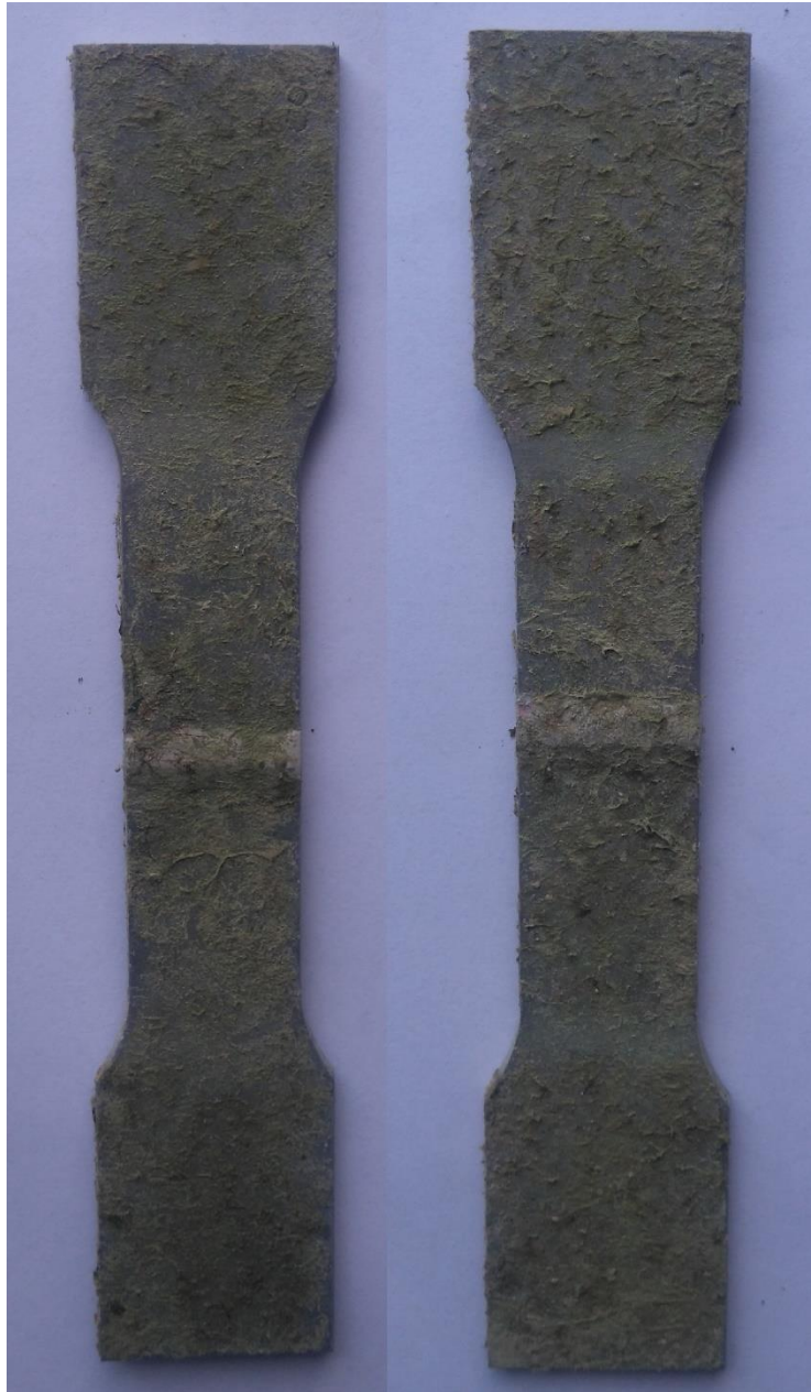
Slika 6.7 Obraštanje uzoraka 9 (desno) i 11(lijevo)
