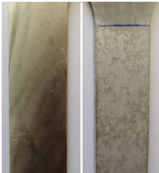
Slika 6.6 Izgled površine uzorka 12 prije (lijevo) i poslije (desno) ispitivanja
