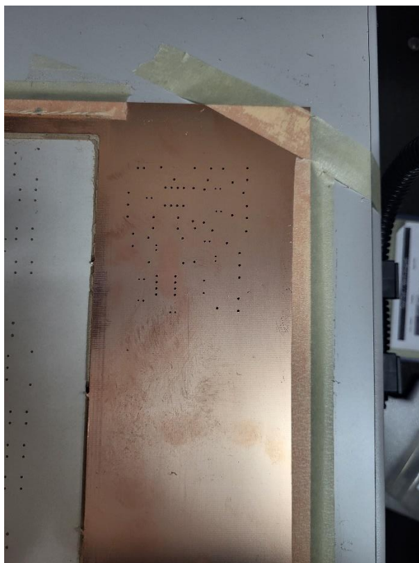
Slika 11. Rupe na mjestima predviđenim za komponente
