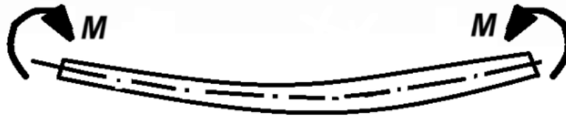
Slika 1.1.- Opterećenje na čisto savijanje štapa
