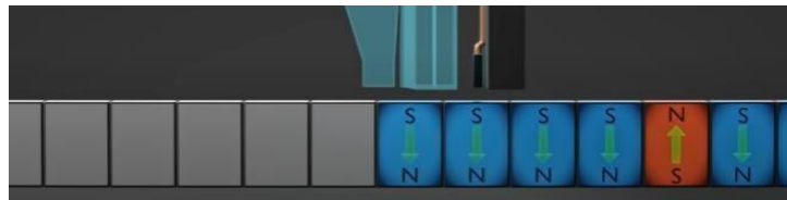
Slika 4.1 Presjek metalnoga diska kod vanjskog tvrdog diska
