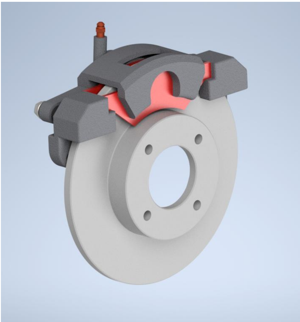
Slika 1.15 – Renderirani izometrijski prikaz modeliranog kočionog sklopa [13]
