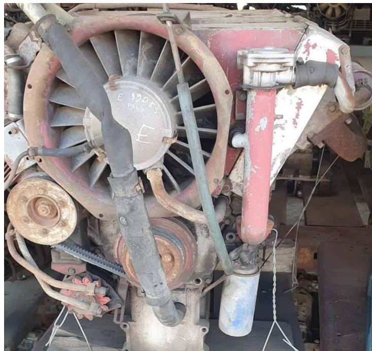
Slika 2.1- Dizelski V6 motor zračno hlađen
